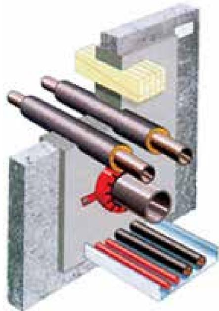
Der Einsatz von Brandabschottungen, wie beispielsweise Kabel- und Rohrabschottungen in Wänden und Decken, die Brandschutzanforderungen unterliegen, ist gesetzlich geregelt und darf keinesfalls vernachlässigt werden.
